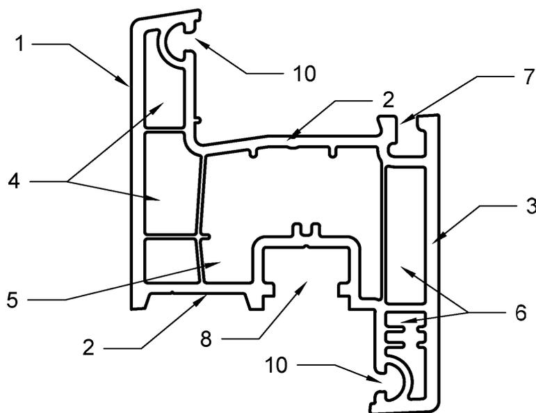
а) - поперечное сечение профиля коробки; б) - то же, створки
